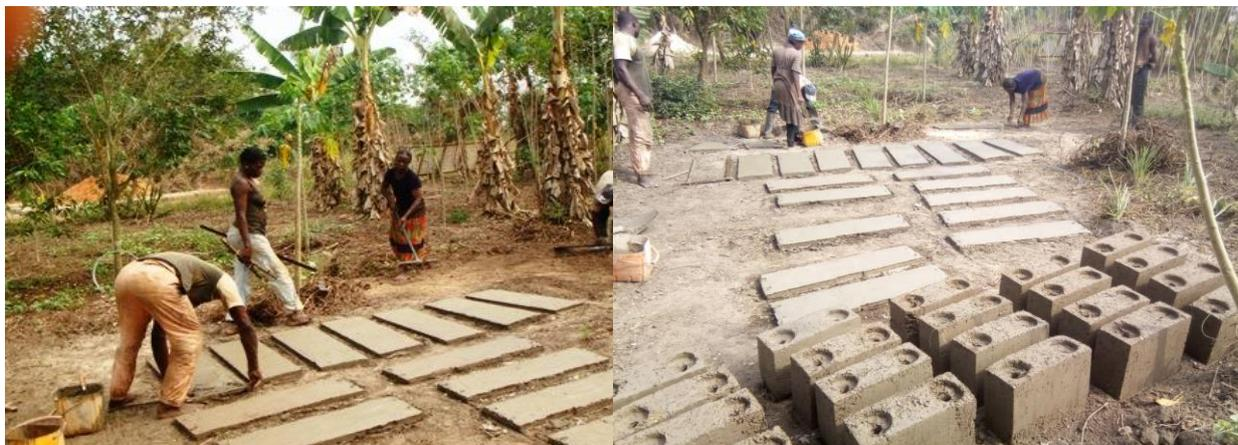
**Photo 7 : Fabrication des compartiments de ruche**
